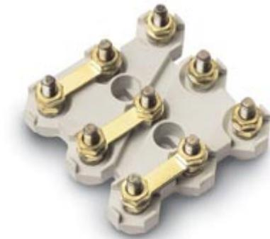
Utili per l'alimentazione di dispositivi ausiliari (ad esempio: freno elettromagnetico in corrente continua, servoventilazione assistita, termoprotettori bimetallici incorporati negli avvolgimenti del motore, sonde PTC, ecc.), i cui collegamenti volanti non sono ammessi dalle normative. La presenza del nono perno serve per le doppie tensioni. N.B. Siglatura a discrezione del cliente.
