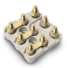
Utili per l'alimentazione di dispositivi ausiliari (ad esempio: freno elettromagnetico in corrente continua, servoventilazione assistita, termoprotettori bimetallici incorporati negli avvolgimenti del motore, sonde PTC, ecc.), i cui collegamenti volanti non sono ammessi dalle normative. La presenza del nono perno serve per le doppie tensioni.
